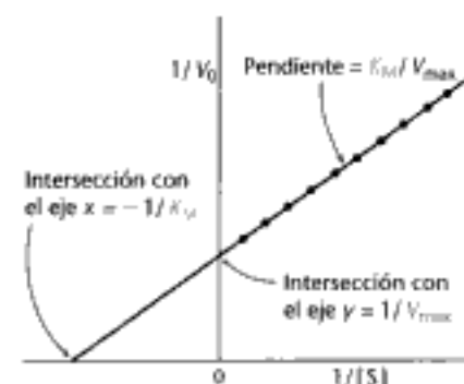
Figura 8.13 Representación doble recíproca o de Lineweaver-Burk. Una representación doble recíproca de la cinética de un enzima se genera representando 1/V_0 en función de 1/[S] . La pendiente es K_M/V_{max} , la intersección con el eje vertical es 1/V_{max} y la intersección con el eje horizontal es -1/K_M .
