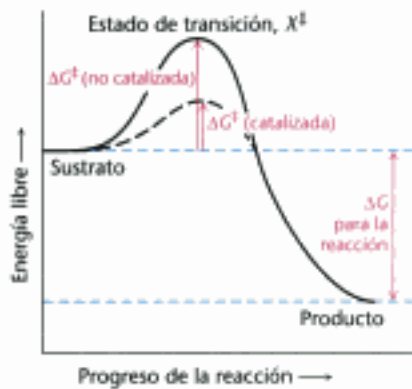
Figura 8.3 Los enzimas disminuyen la energía de activación. Los enzimas aceleran las reacciones porque hacen decrecer \Delta G^\ddagger , la energía libre de activación.
