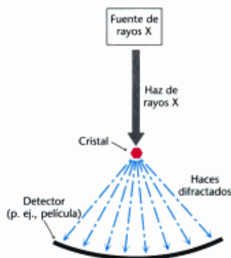
Figura 3.43 Un experimento de cristalografía de rayos X. Una fuente de rayos X genera un haz, que es difractado por un cristal. El patrón de difracción resultante se recoge en un detector.
